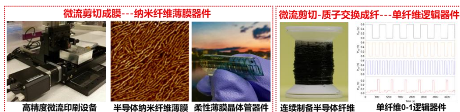
图 1. 基于剪切加工的半导体纤维器件制备: (左图) 高精度微流印刷设备用于半导体纳米纤维薄膜的制备及柔性器件构筑; (右图) 千米级半导体纤维的连续纺丝制备及单纤维逻辑器件构筑。
